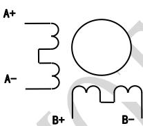
8线电机，串联接法，大力矩输出。
