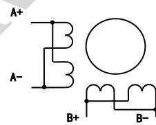
8线电机，并联接法，高速输出。
